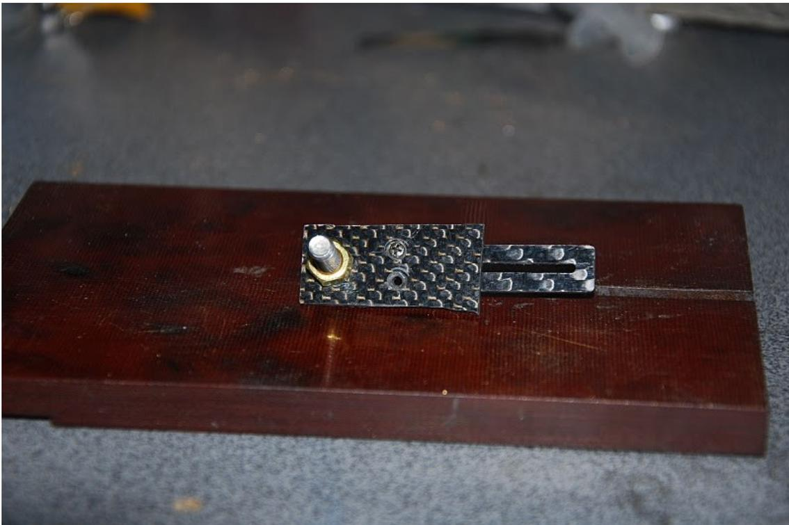
Pour faciliter la mise en place des 2 vis, j'agrandis à 2 mm les trous de l'épaisseur. Ceux sur le porte-guide seront taraudés par les vis. Avec un foret de 4 mm on chanfreine les trous de l'épaisseur
