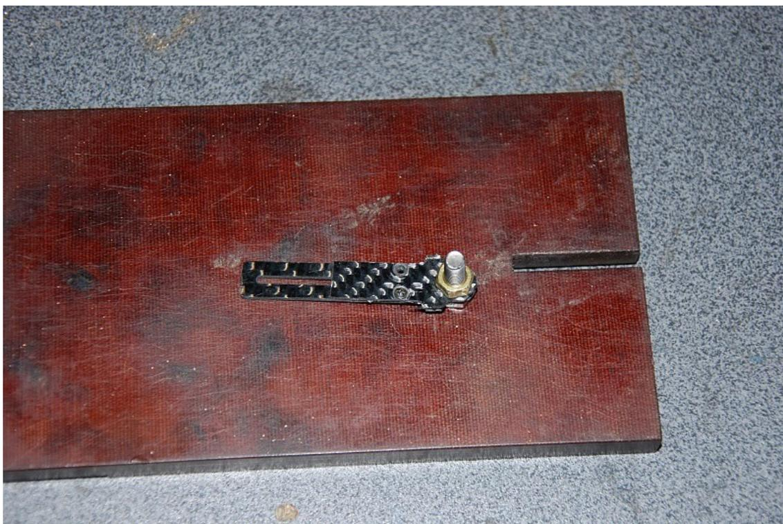
La finition se fait à la lime ou à la dremel. Le plus important est la partie arrondie. Essayez avec le guide pour contrôler que l'arrondi ne frotte pas sur le flag.
